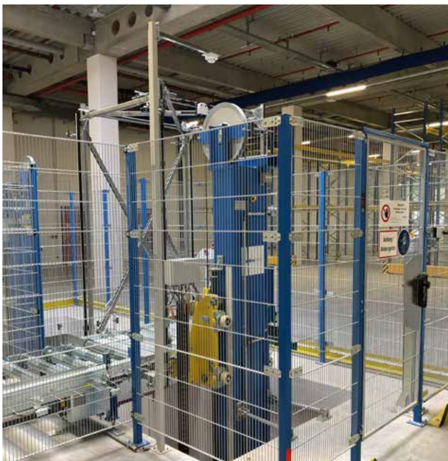
Vertikalumsetzer mit Fördertechnik
