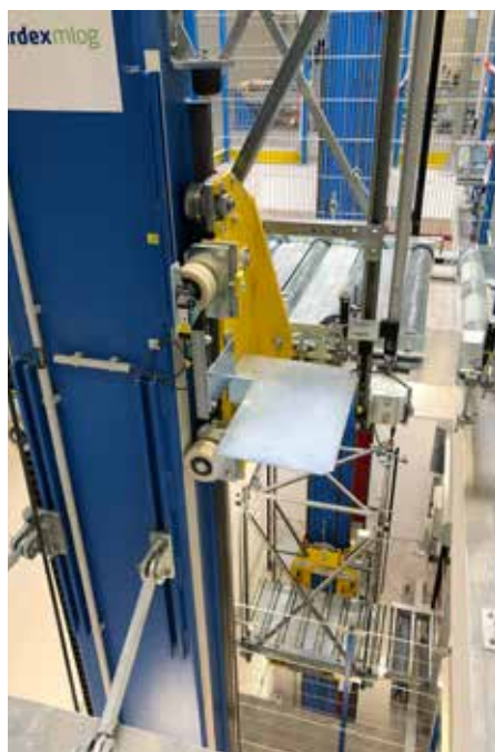
Die beiden Vertikalumsetzer bedienen alle drei Ebenen.
